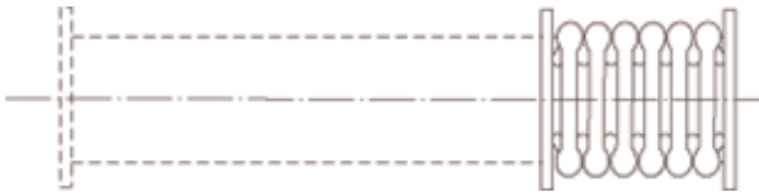
Fig. 2.4.1.1.1 Axial mode of collapse
